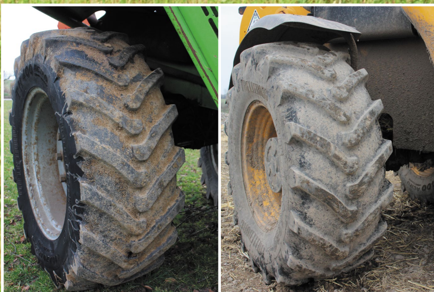
Trelleborg TH400 är ett Agro Industrial radialdäck som är konstruerat för bl.a. teleskoplastare och grävlaster. Här är det storlekarna 400/70R24 och 460/70R24 som används.
