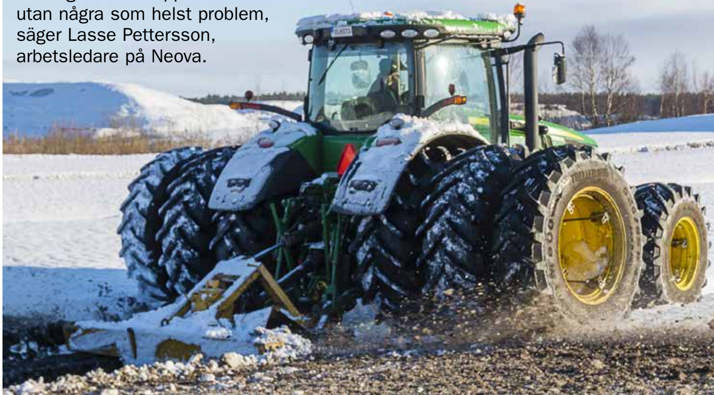
Neovas John Deere-traktor är utrustad med dubbelmontagesystemet DUO500 både fram och bak. Däcken man valt är Trelleborg 710/70R42 TM900 HP och 520/85R42 TM600 ytterst.
