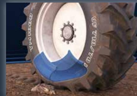
La carcasse robuste absorbe les contraintes transmises lors des différentes opérations de fonctionnement sans compromettre la flexibilité, cruciale pour garantir le confort de conduite à très basse pression, tant dans les champs que sur route.
