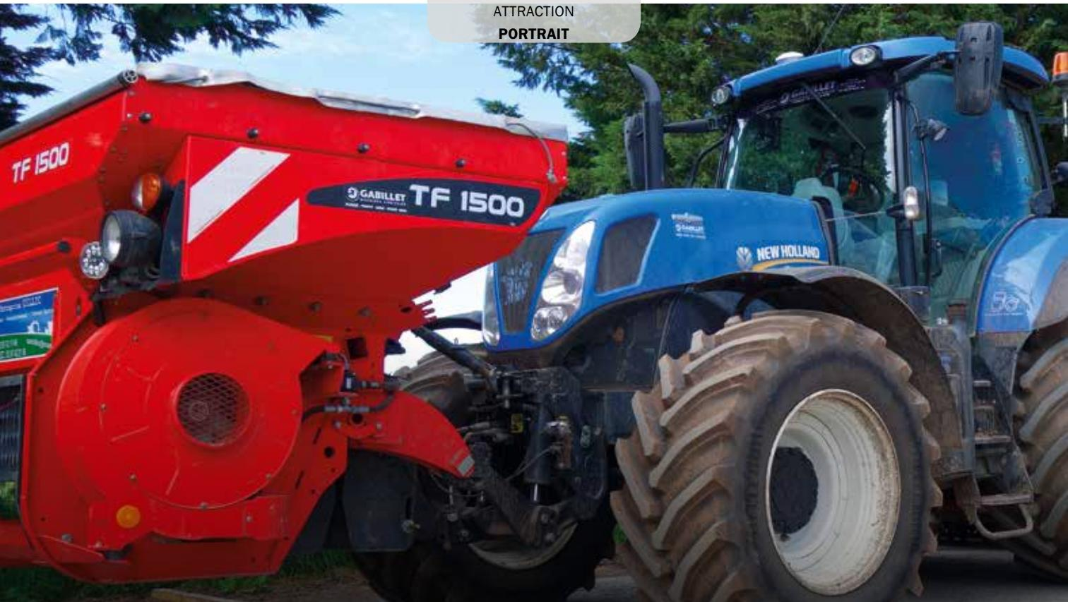
**1 bar toute l'année : l'entreprise Oillic sème jusqu'à 800 ha de maïs par an ; elle exploite, entre autres, ce New Holland T7.250, un tracteur équipé de pneumatiques premium TM1060 Trelleborg de dimension VF 710/60R42 à l'arrière et VF 600/60R30 à l'avant.**
