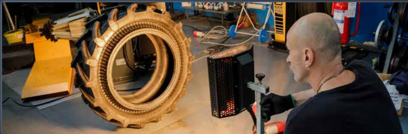
**⚠ Importante:** Para facilitar el montaje, recomendamos calentar el PneuTrac®. No siga adelante con la operación de montaje si la temperatura del PneuTrac® es inferior a 10°C.
