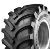
Especialmente desenvolvido para o serviço de arraste de toras, com penetração máxima e resistência a cortes. Proporciona maior vida útil ao pneu, sob as mais severas condições de operação. As lonas com camadas de aços protegem a carcaça contra tocos, pedregulhos e rochas.
