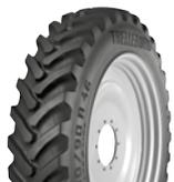
O TM150 é a resposta da Trelleborg à nova geração de fertilizadoras e pulverizadores automotores de alta potência. Fabricado com a tecnologia VF, o novo pneu é capaz de suportar cargas elevadas, ao mesmo tempo que oferece baixa compactação do solo, minimizando os sulcos e impulsionando a produtividade da colheita.
