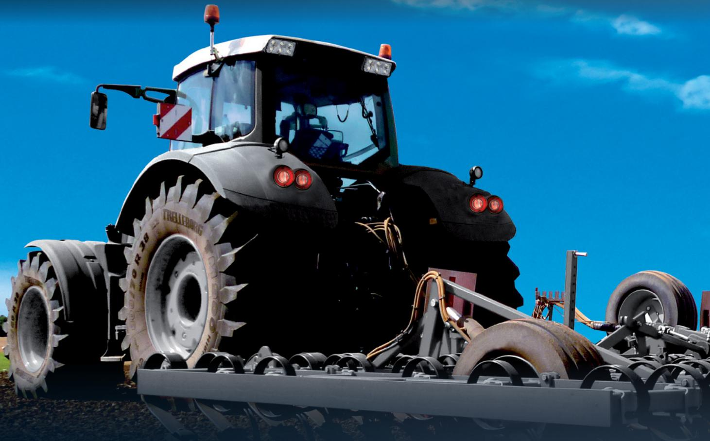
Desenvolvido juntamente com os principais fabricantes de máquinas agrícolas, o TM900 High Power equipa tratores de 250 a 400hp a uma velocidade de até 65km/h\*. Proporciona excelente tração, grande capacidade de autolimpeza, conforto, menor resistência ao rolamento, menor compactação do solo e baixo consumo de combustível. Essas características, fazem do Trelleborg TM900 High Power o mais avançado pneu radial agrícola extragrande.
