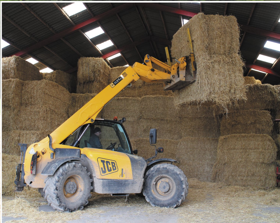
Lars Wolf, Kegnes Maskinstation på Sydals, hanterar varje år 15 000 storbalar med sin JCB 531-70 teleskoplastare och är mycket nöjd med stabiliteten som TH400-däcken ger teleskoplastaren.
