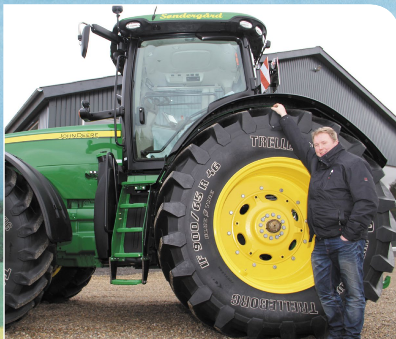
Gårdsägare Henrik Søndergård som har köpt nya John Deere 8.370R måste sträcka upp armen helt för att nå överdelen av det 231 centimeter höga däcket Trelleborg IF 900/65R46 TM1000.
