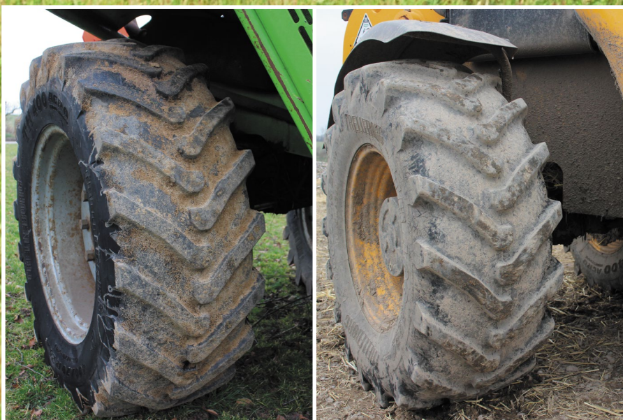
Trelleborg TH400 er et Agro Industrial radialdekk som er laget til blant annet teleskoplasterere og gravemaskiner. Her er det størrelsene 400/70R24 og 460/70R24 som blir brukt.
