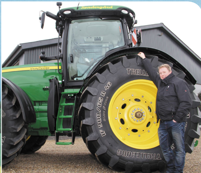
Gårdejer Henrik Søndergård, som har købt den nye John Deere 8.370R, skal have armen strakt helt ud, for at nå øverste klods på det 231 centimeter høje Trelleborg IF 900/65R46 TM1000 dæk.
