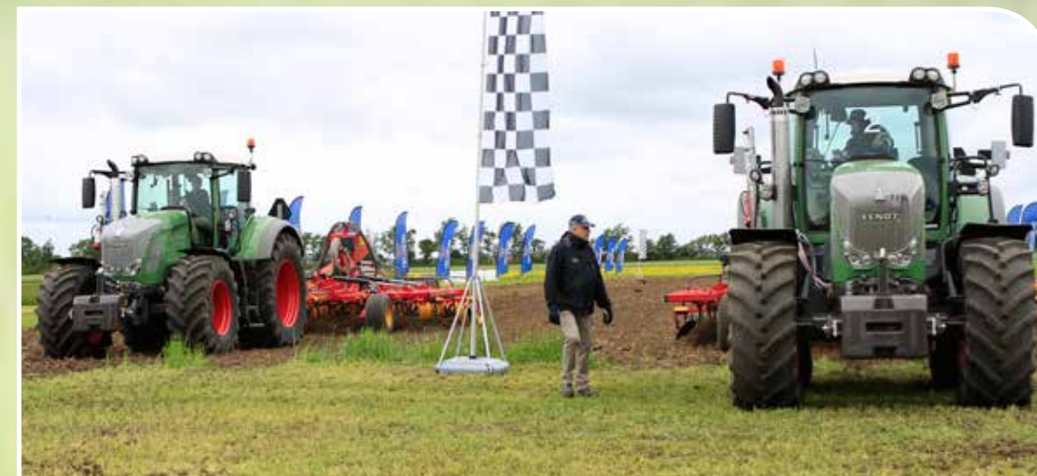
0,8 bariin paineistetuilla TM1000 High Power -renkailla varustettu Fendt 828 -traktori on maalissa noin neljä sekuntia nopeammin kuin traktori, jossa on TM900 High Power -renkaat, joiden ilmanpaineet ovat edessä 1,5 baria ja takana 1,6 baria.
