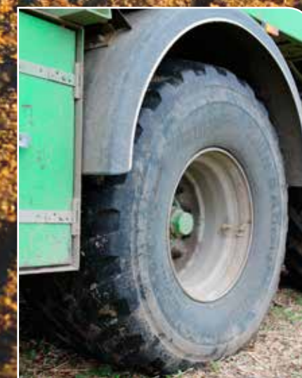
Huuhteluvaunuun on asennettu 560/60R22.5-kokoiset Trelleborg Twin Radial-renkaat. Itäjyllantilaisen yrittäjän mielestä renkaat kantavat hyvin märällä maalla, puhdistuvat tehokkaasti ja toimivat vakaasti maantieajossa.
