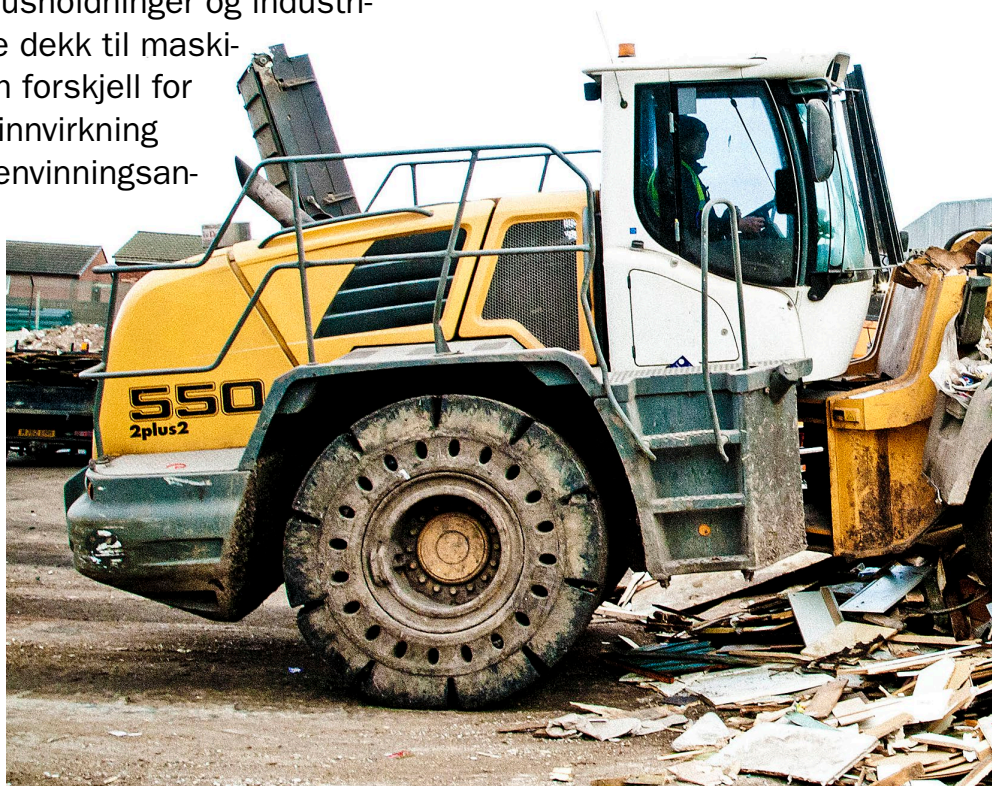
Brawler-dekk i drift, på en av Kal Tires lastere ved et avfallshåndteringsanlegg i Derbyshire, England.
