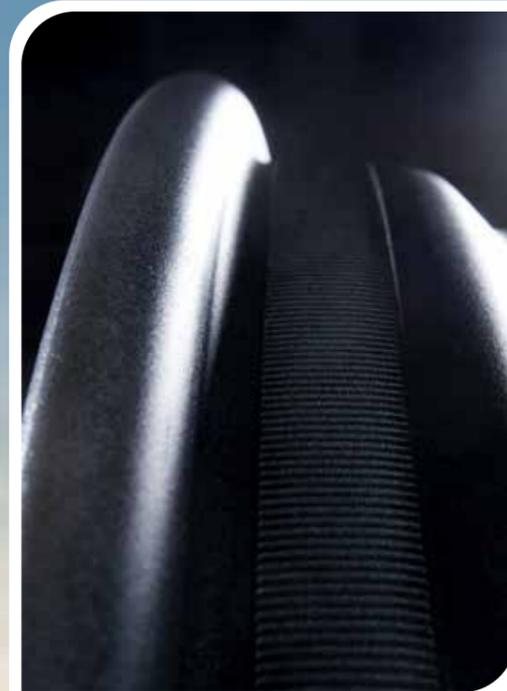
*La zigrinatura è stata aumentata del 50% rispetto alla versione standard. Questa, combinata con la vernice speciale ad alta aderenza, massimizza le caratteristiche di attrito del cerchio quando il pneumatico viene montato.*
