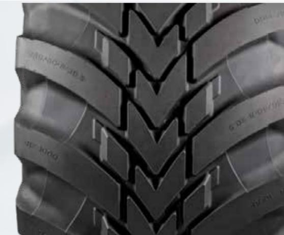
terreno argilloso. Questa caratteristica riduce lo slittamento, migliora le prestazioni complessive del pneumatico e aiuta gli operatori a rispettare le normative sulla pulizia delle strade.
