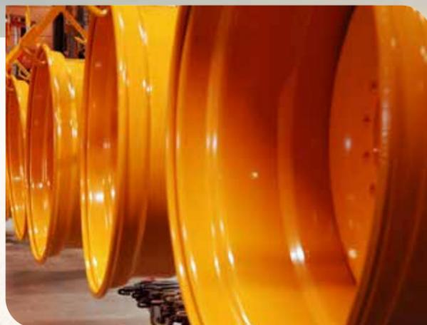
tradizionale dei cerchi. Progettato specificamente per pneumatici agricoli di grandi dimensioni, questo profilo avanzato va oltre la semplice funzionalità, offrendo numerosi vantaggi: **facilita e velocizza il montaggio del pneumatico, accelera il gonfiaggio degli pneumatici a bassa pressione e migliora l'efficienza complessiva** -
